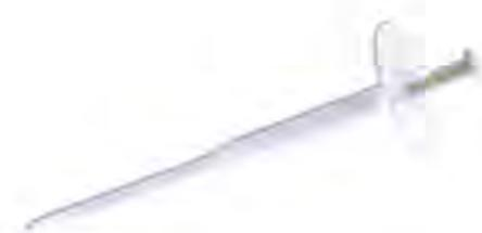
TACO UNIVERSAL DE PERCUSIÓN CON CLAVO (PREMONTADO) EN ACERO Y CABEZA DEL CLAVO EN MATERIAL SINTÉTICO PARA LA FIJACIÓN DE PANELES AISLANTES EN HORMIGÓN, LADRILLOS MACIZOS Y PERFORADOS. PROFUNDIDAD DE ANCLAJE 45 MM. CERTIFICADOS SEGÚN ETAG 014 (CATEGORÍA DE EMPLEO A B C E D).
