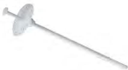
TACO UNIVERSAL DE PERCUSIÓN CON CLAVO EN MATERIAL SINTÉTICO Y DISCO FLEXIBLE HOMOLOGADO PARA SU USO EN ESTRUCTURAS DE HORMIGÓN, LADRILLOS MACIZOS Y PERFORADOS. PROFUNDIDAD DE ANCLAJE 25 MM. CERTIFICADO ETA-14/0130 (CATEGORÍA DE EMPLEO A B C). EL DISCO FLEXIBLE ASEGURO UNA EXCELENTE FIJACIÓN SOBRE EL PANEL AISLANTE INCLUSO EN CASO DE ORIFICIO DE ENTRADA LIGERAMENTE INCLINADO.
